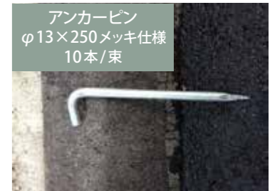
● 滑動防止用にラップ部に打設 ● 外周に500mmピッチで打設
