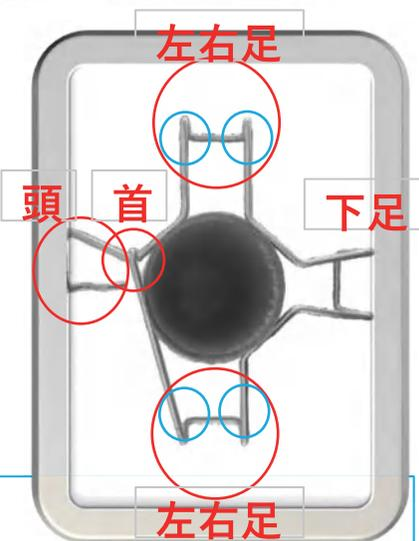
センターキーパーの頭が鉄筋に引っ掛けられるようになっています。(頭の向きは鉄筋の重なり方向で位置関係が変化します。) 頭を交差する鉄筋の下側の鉄筋に引っ掛け、残り三辺(左右足・下足)を鉄筋に押し込んで頂くと設置完了です。その後、ボイド管を押し込んでください。
