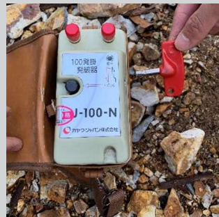
NRC 破碎 （非火薬破碎）
